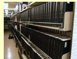
耐久性の高い金属のバーが、高所からの資料の落下を防ぎます。
